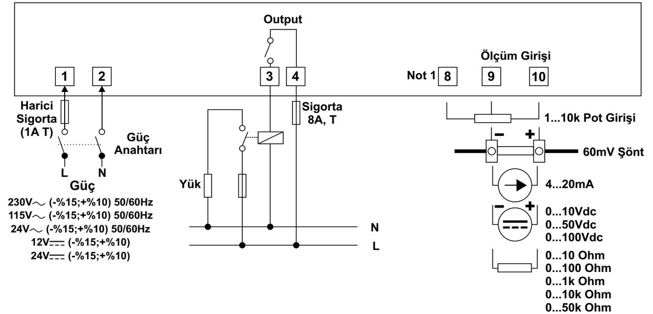
**Not1:** Belirtilen terminalde 4...20mA girişte sensör beslemesi için 10...14Vdc, Potansiyometre girişinde 5Vdc bulunur.
