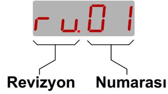
Cihaz enerjilendiđinde gsterge zerinde 3 saniye boyunca revizyon durumu gsterilir. Cihaz zerindeki donanım veya yazılım deđiŖikliklerinde revizyon numarası arttırılır. Revizyon numarasına bađlı tm deđiŖiklikler kayıt altına alınır.
