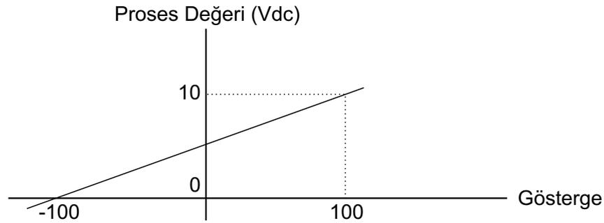
**Örnek:** Proses girişi 0...10 Vdc iken cihazın 0Vdc değerinde 100, 10Vdc değerinde 0 göstermesini istiyorsanız, skala alt ve üst parametre değerlerini sırasıyla 100, 0 değerlerine ayarlayınız.
