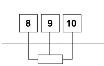
Potansiyometre bağlantısını şekilde gösterildiği gibi yapınız. Potansiyometre orta uç bağlantısına dikkat ediniz.
