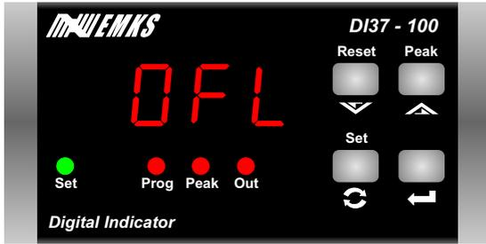
Cihazın proses giriŖine bađlı olan sensrn kopması durumunda OFL mesajı verilir. Kontrol ıkıŖı parametre ile belirlenen konumda tutulur. Bu durumda kullanıcının cihaza bađlı sensr kontrol etmesi, arızalı ise deđiŖtirmesi gerekmektedir.
