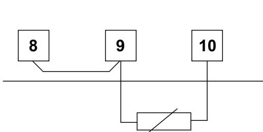
PTC bağlantısının yapıldığı kablolar aynı çapta ve aynı uzunlukta olmalıdır. Kullanılacak kablo kesiti minimum 1.5mm<sup>2</sup> olmalıdır.
