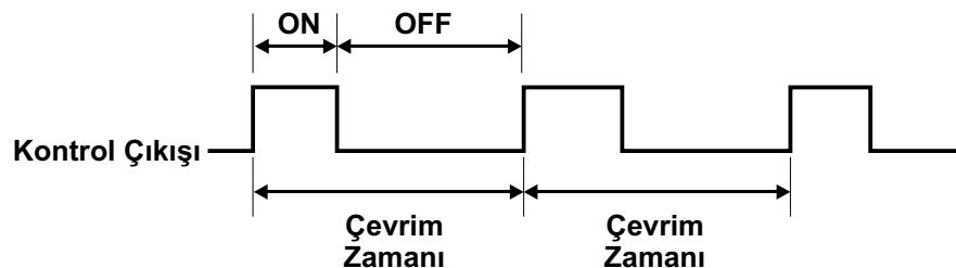
**Röle Çıkışı :** Kararlı bir proses kontrol için çıkış periyodunun kısa olması tavsiye edilmektedir. Röle kontaklarının mekanik ömrülerinden (açma/kapama adetleri) dolayı kısa çıkış periyotlarında kullanılmamaları gerekmektedir. 30 saniyeye yakın değerlerde veya daha büyük değerlerde, röle çıkışının kontrol çıkışı olarak kullanılması gerekmektedir.
