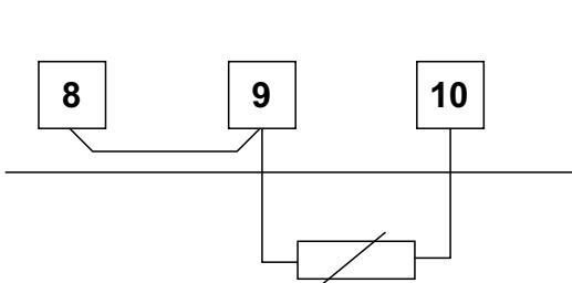
PT-100 bağlantısının yapıldığı kablolar aynı çapta ve aynı uzunlukta olmalıdır. Kullanılacak kablo kesiti minimum 1.5mm<sup>2</sup> olmalıdır.
