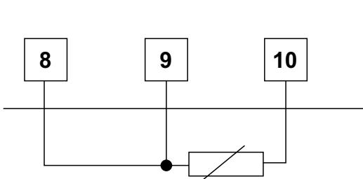
PT-100 bağlantısının yapıldığı kablolar aynı çapta ve aynı uzunlukta olmalıdır. Kullanılacak kablo kesiti minimum 1mm<sup>2</sup> olmalıdır.
