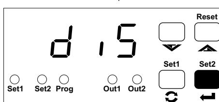
Arttırma ve eksiltme butonları ile mevcut durumu değiştirebilirsiniz. Mevcut durumun kaydedilmesi ve çalışma ekranına dönmek için set2 butonuna basınız.
