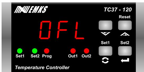
Cihazın proses girişine bağlı olan sensörün kopması durumunda OFL mesajı verilir. Kontrol çıkışları parametre ile belirlenen konumda tutulur. Bu durumda kullanıcının cihaza bağlı sensörü kontrol etmesi, arızalı ise değiştirmesi gerekmektedir.
